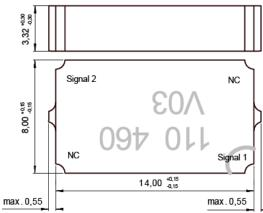
Die Layoutempfehlung gilt für eine 1,5 mm dicke FR-4 Grundplatine. Der Anschluss "Signal1" ist mit einem Markierungsbogen gekennzeichnet.
